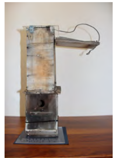
Caixa niu d'ICONA adaptada per a la instal·lació d'una càmera
